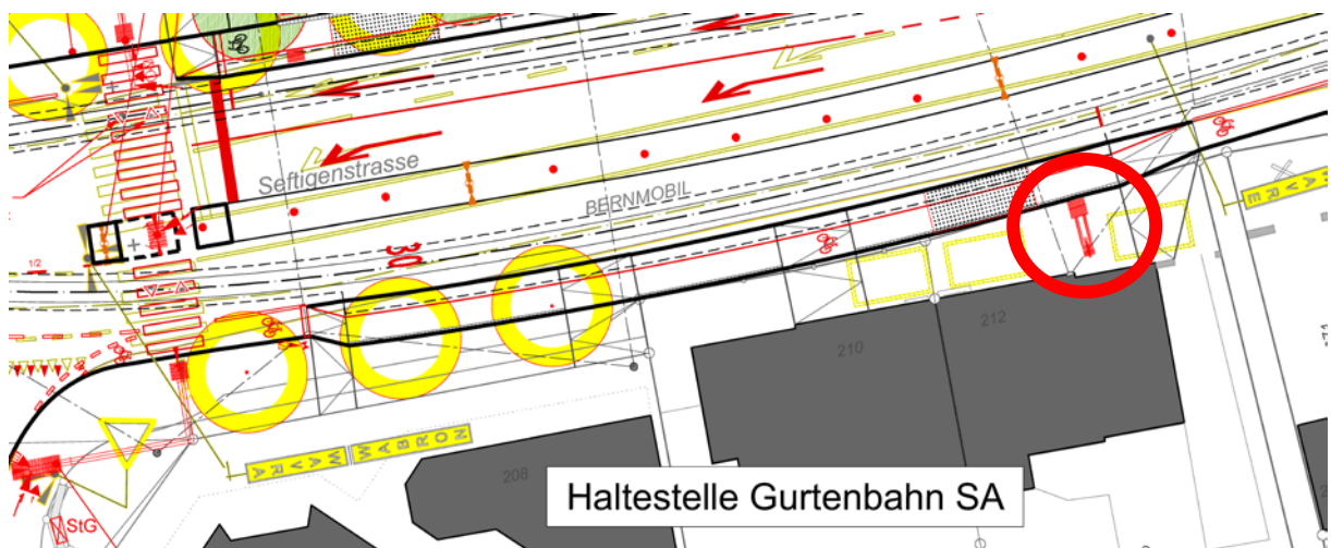
Abbildung 14: Haltestelle Gurtenbahn stadtauswärts, Blinderquadrat versetzt
